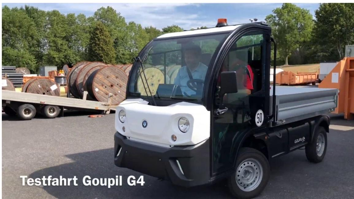
Das Fahrzeug wird aufgrund seiner Wendigkeit vorrangig an Friedhöfen eingesetzt. Bei dem 2016 erworbenen Fahrzeug waren bauartbedingt sehr wartungsintensive Batterien mit einem relativ kurzen Lebenszyklus verbaut. Die Batterien sind mittlerweile verschlissen und lassen sich nicht mehr aufladen.
